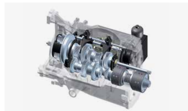
Przekładnia CVX – bezstopniowa jazda w zakresie prędkości 0-40 km/h
