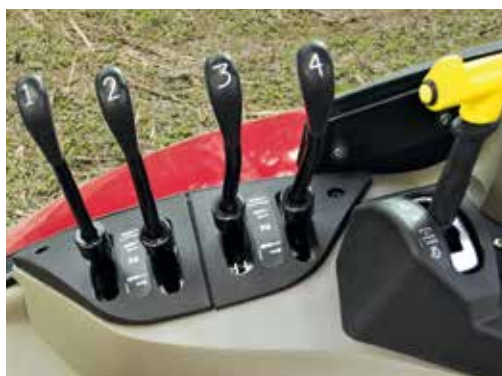
Dostępne nawet cztery mechaniczne zawory hydrauliki zewnętrznej w modelach Puma oraz Puma CVX 150-165.
