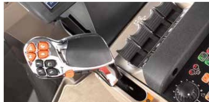
Multicontroller™ umożliwia zmianę biegu bez aktywowania sprzęgła.
