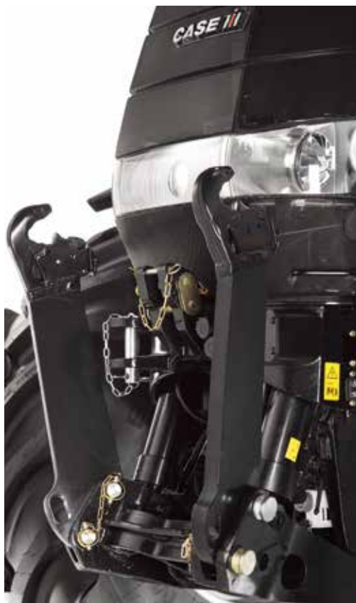
Pracujący płynnie, zintegrowany przedni układ zawieszania o udźwigu do 3785 kg.
