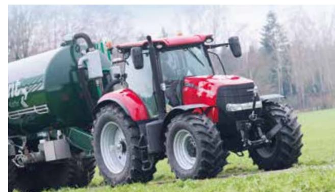
System Active Stop utrzymuje ciągnik w stałym położeniu bez konieczności naciskania hamulców
