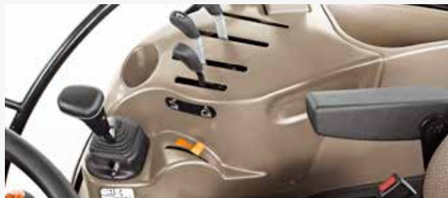
W gamie maszyn Farmall A można zamontować maksymalnie trzy mechanicznie sterowane tylne zawory zewnętrznego układu hydraulicznego.
